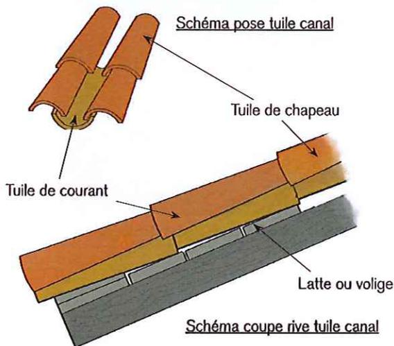
égouts seront réalisés de manière traditionnelle au moyen de tuiles demi-rondes scellées au mortier de chaux naturelle.
